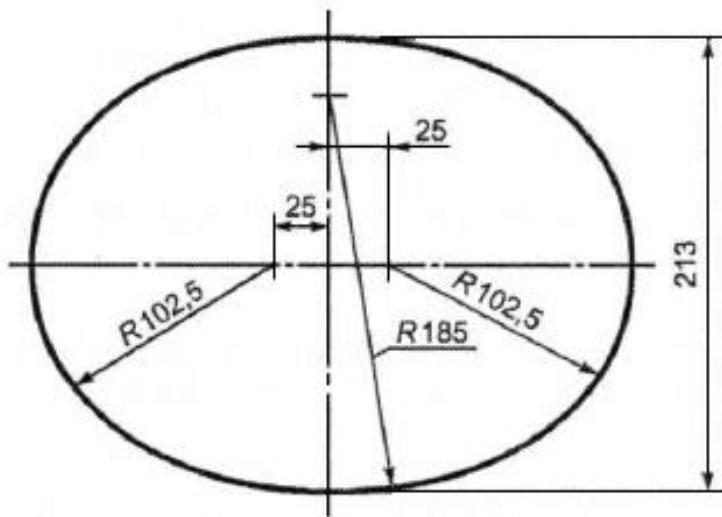
Рисунок 3 - Размеры отверстия в основании термокамеры
