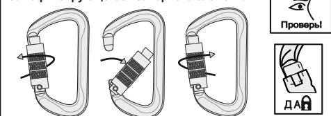
Рис. 5. Приложение нагрузки для карабинов класса В
