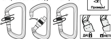
Рис. 4. Открытие / закрытие / фиксация самофиксирующегося запорного элемента.
